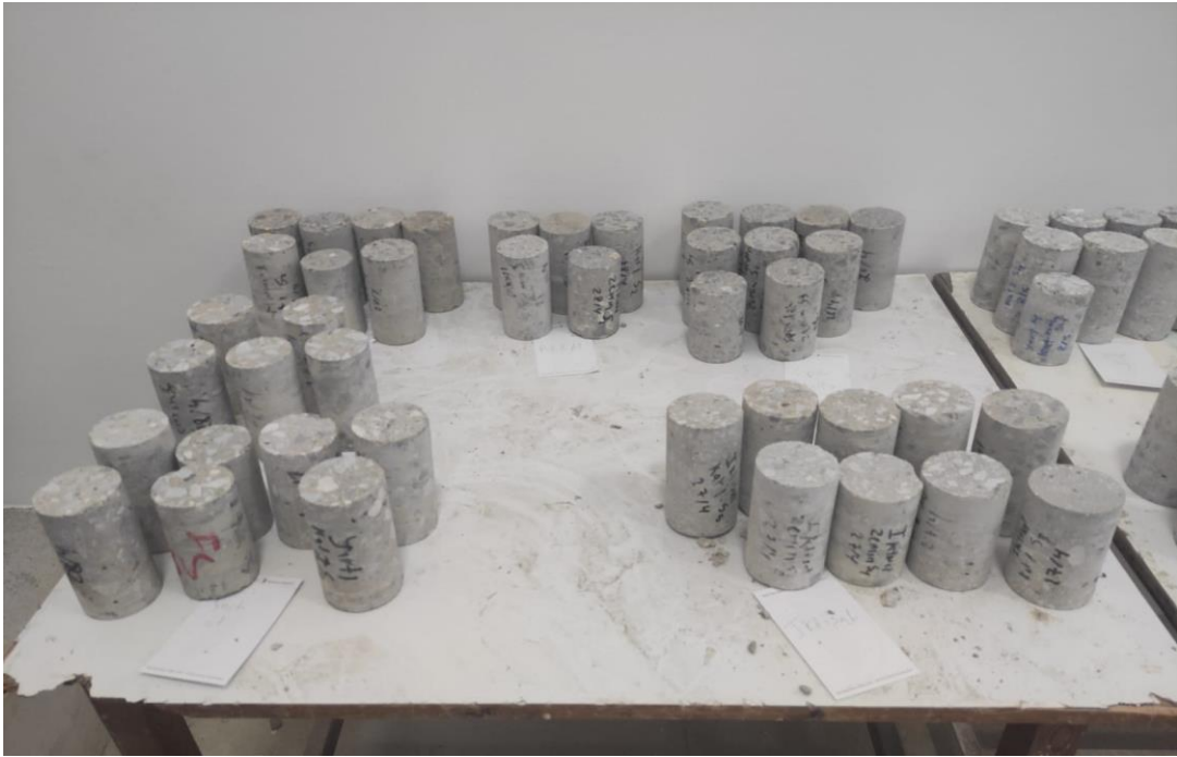
Şekil 31. Deneye hazırlanmış beton numuneleri.
