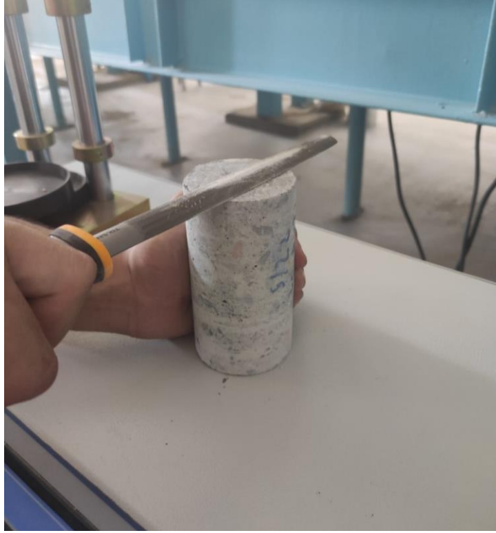
Şekil 26. Yüzeyi yeterli düzlüğü sahip olamayan karotun pürüzlülüğünün giderilmesi işlemi.
