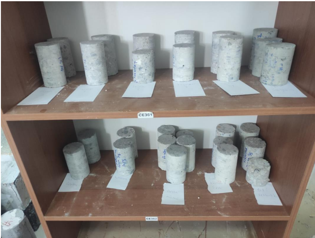
Şekil 35. Deneye hazırlanmış beton numuneleri.
