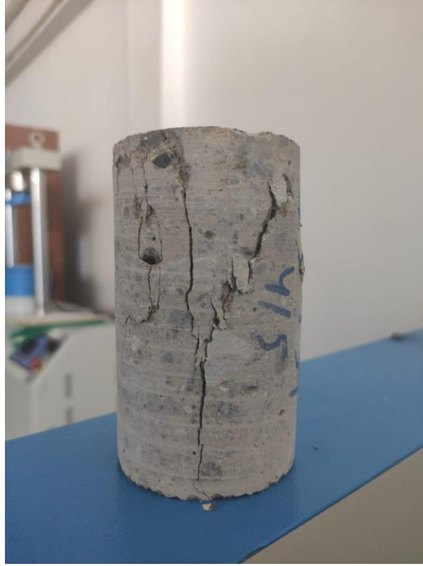
Şekil 38. Teste tabii tutulmuş numunenin kırıldıktan sonraki görüntüsü.
