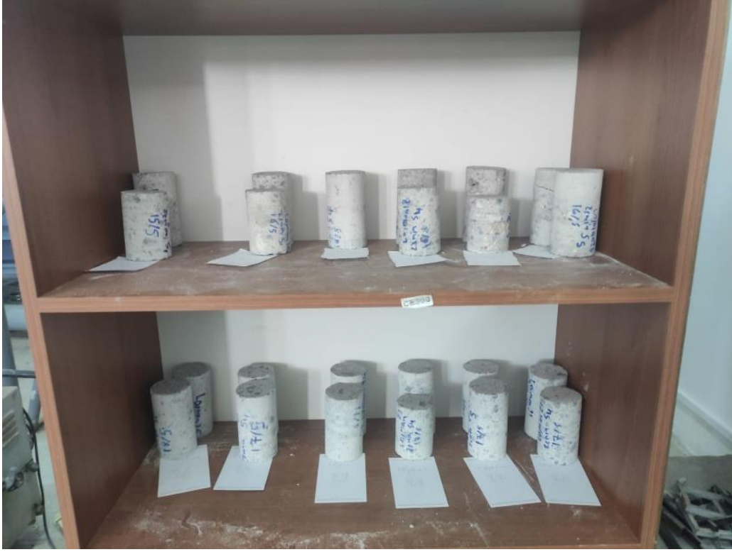
Şekil 32. Deneye hazırlanmış beton numuneleri.
