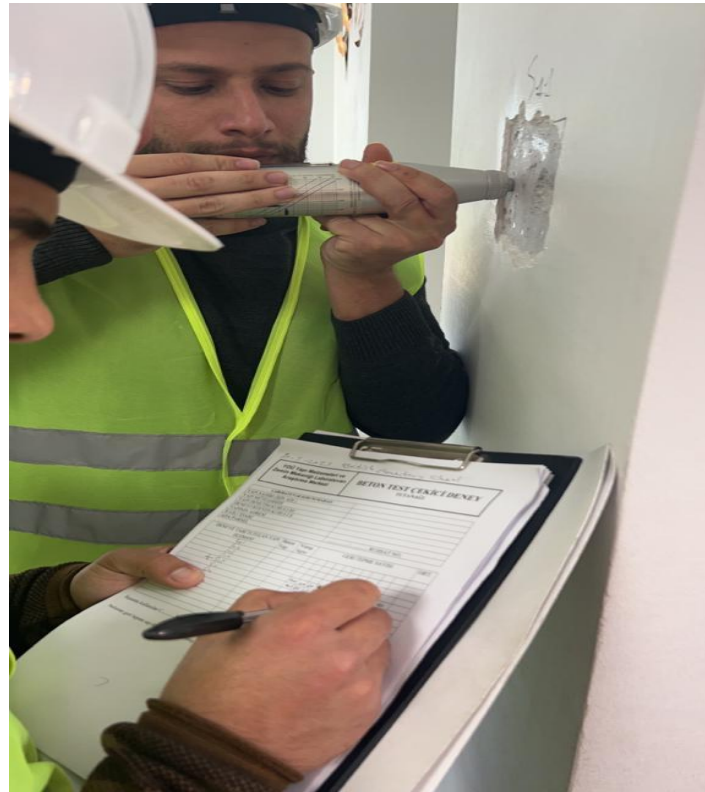
Şekil 11. Schmidt çekici uygulaması sırasında ham verilerin kaydedilmesi.
