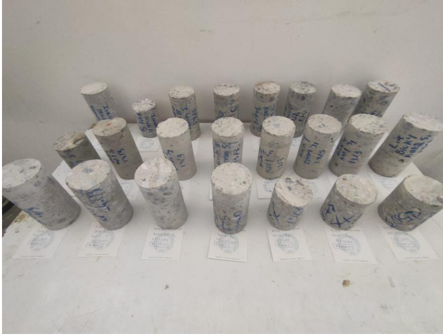
Şekil 29. Beton karot numunelerinin deneye hazır hale getirilme süreci.
