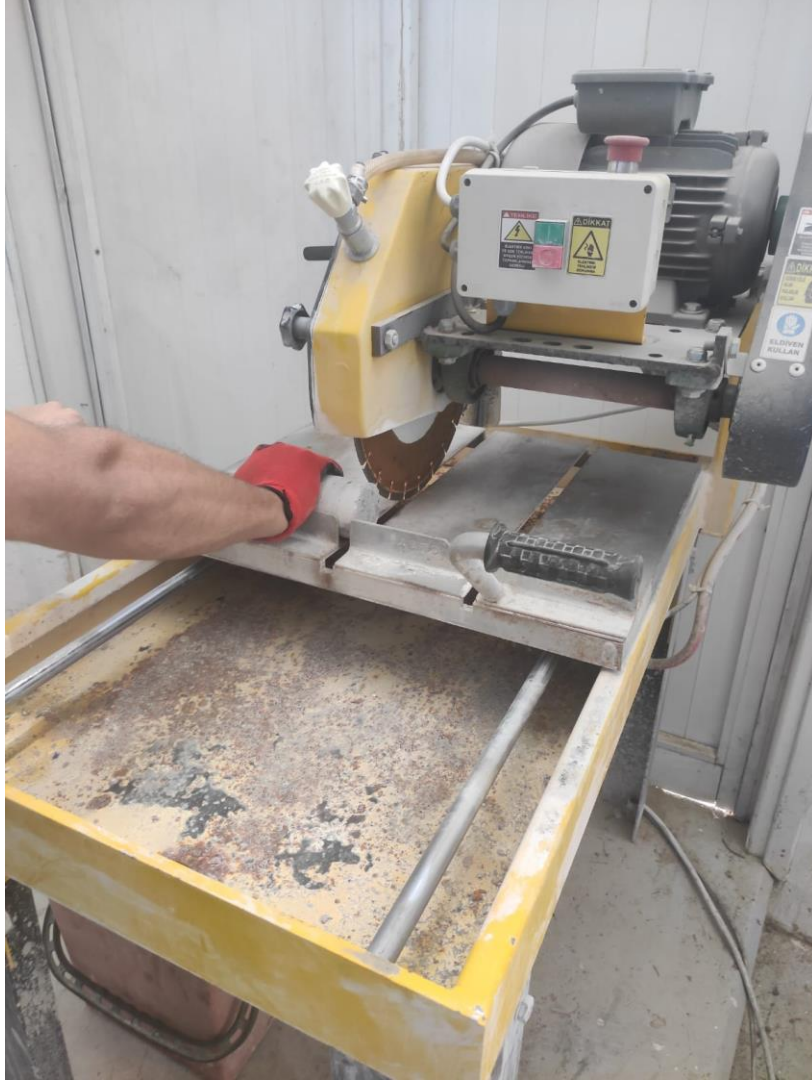
Şekil 23. Beton karotu numunesi kesme makinesinin kullanılışı.
