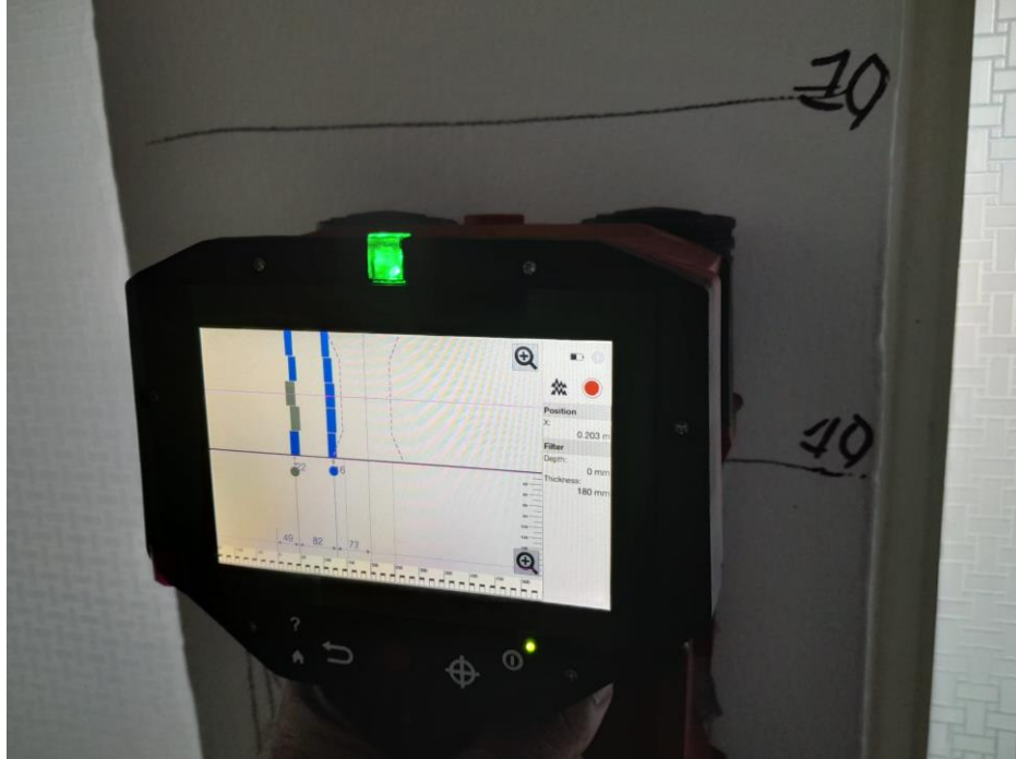
Şekil 16. Hilti PS300 donatı tespit cihazı ile dikey donatıların tespit edilme işlemi.
