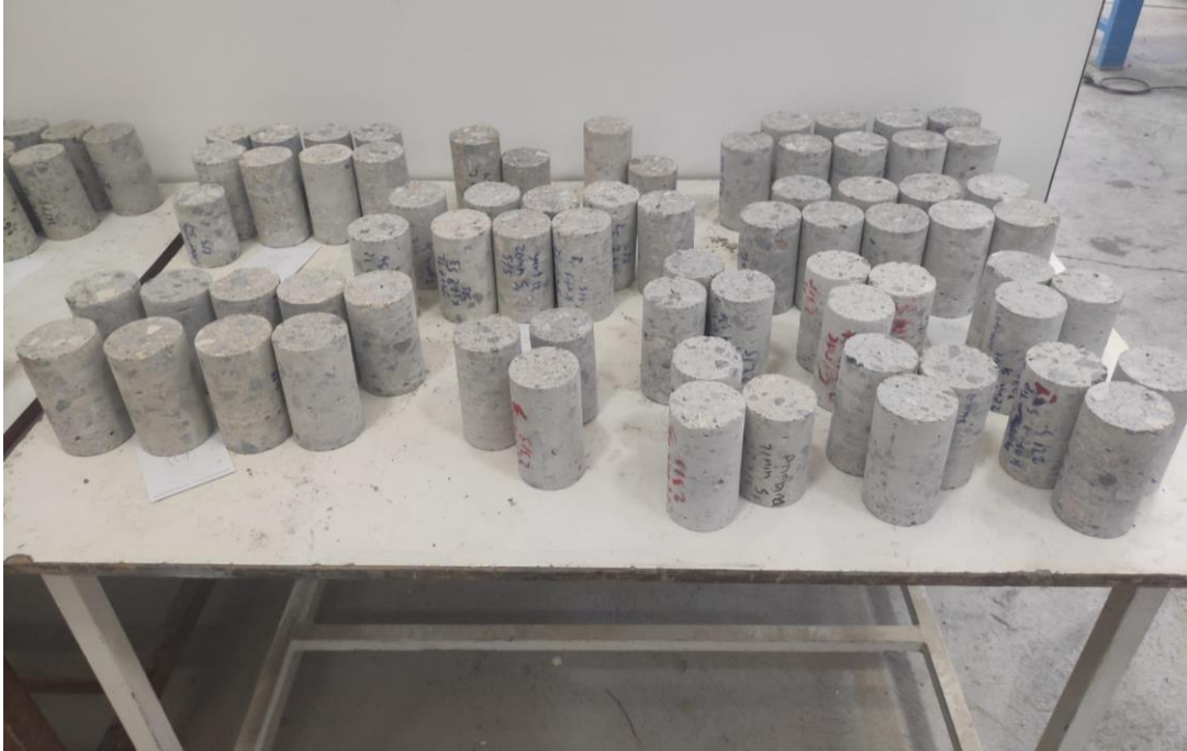
Şekil 33. Deneye hazırlanmış beton numuneleri.
