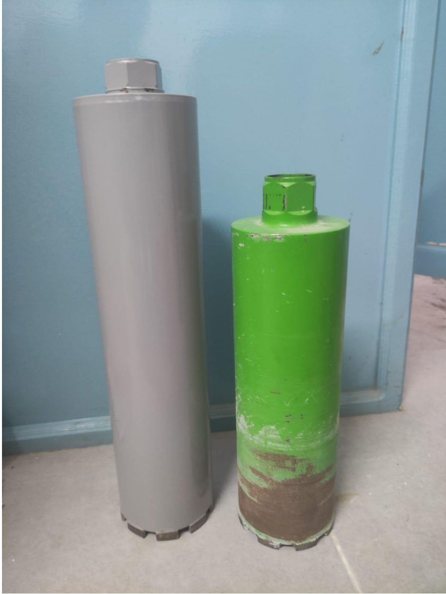
Şekil 18. Beton karot makinesine ait değişebilen uçlar.
