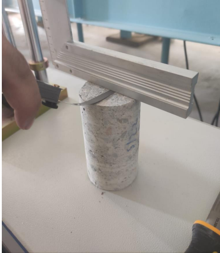
Şekil 25. Karot numunesinin lental çakısı yardımıyla yüzey düzlüğünün kontrol edilmesi.
