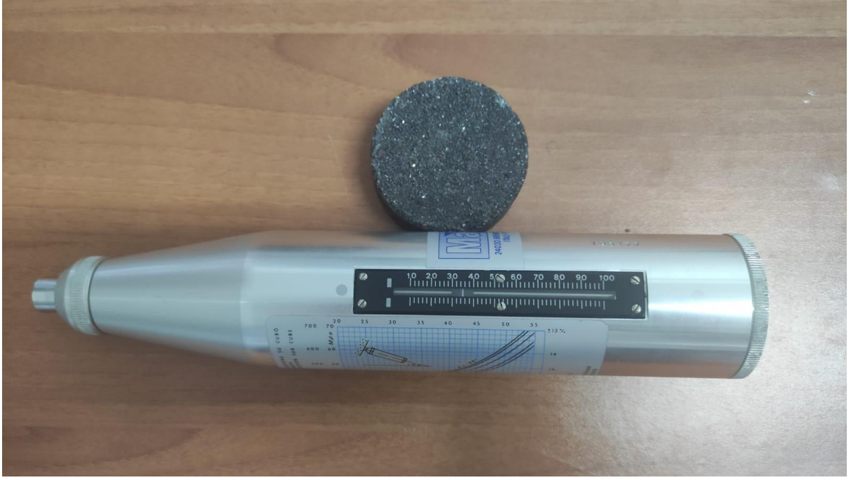
Şekil 9. Schmidt çekici ve beton yüzeyini temizleye yarayan törpü taşı.
