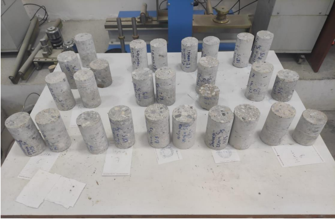
Şekil 34. Deneye hazırlanmış beton numuneleri.
