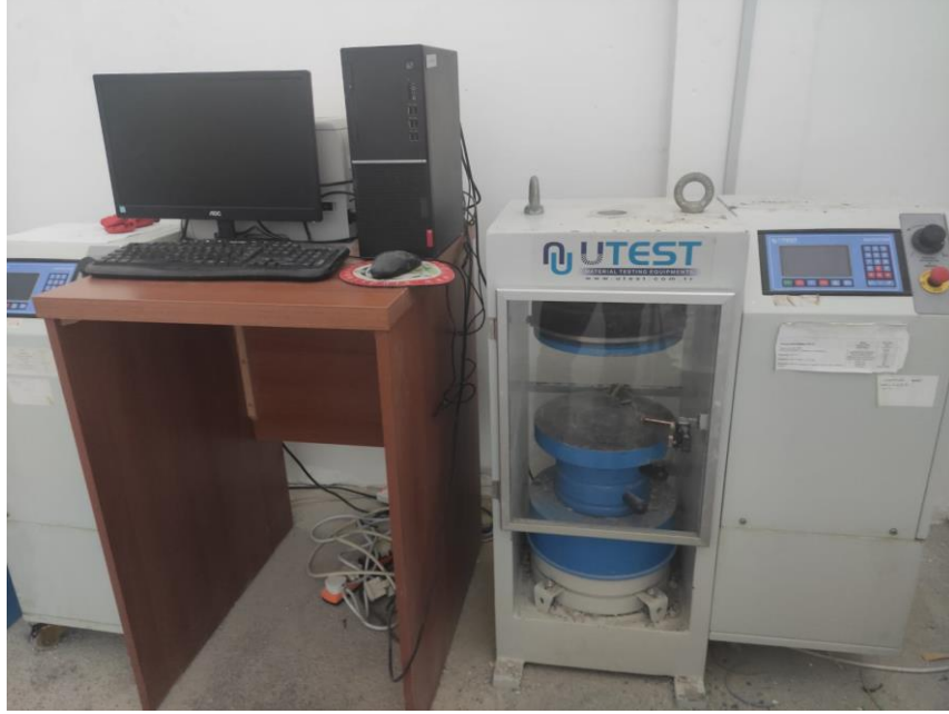
Şekil 36. Karot numunesi dayanımının tespitinde kullanılan beton dayanım test cihazı.
